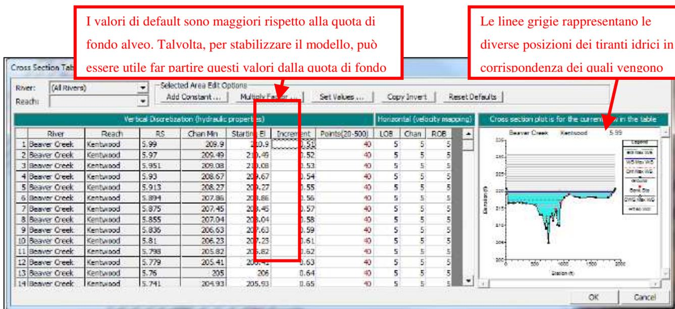
Figura 6.1 – “Hydraulic Table Parameters” per una sezione trasversale nel software HEC-RAS
