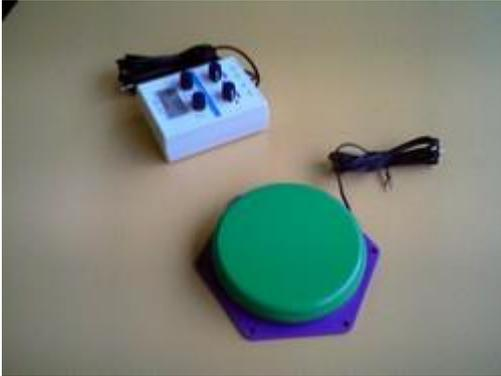
**descrizione:** tastiera con cavetto di collegamento e timer a batteria
